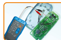
Возможность определения положительного и отрицательного полюсов
