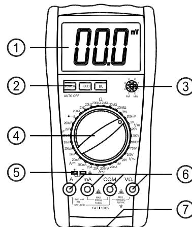
1. Жидкокристаллический дисплей, на котором отображаются измеренное значение и единица измерения.
